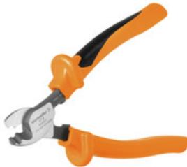
Schneidwerkzeuge für Leiter bis 8 mm, 12 mm, 14 mm bzw. 22 mm Außendurchmesser. Die spezielle Schneidengeometrie ermöglicht ein quetschfreies Schneiden von Kupfer- und Aluminiumleitern mit minimalen Handkräften. Zudem besitzen die Schneidwerkzeuge VDE- und GS-geprüfte Schutzisolationen bis 1.000 V gemäß EN/IEC 60900.
